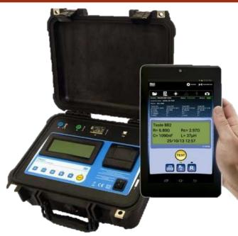
O ensaio é realizado fazendo circular uma corrente através da resistência de difusão de terra e de um eletrodo auxiliar, denominado eletrodo de corrente, e medindo a tensão produzida entre a resistência de aterramento e outro eletrodo auxiliar, fincado no terreno na zona plana do potencial criado pela corrente que circula (Patamar de potencial). O equipamento mede a resistência calculando o quociente entre a tensão e a corrente.
